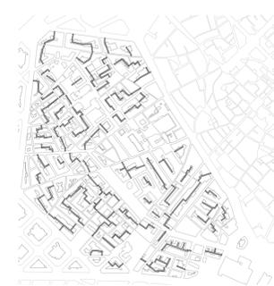
**V. PASARELAS EN LOS INTERIORES.** Un recorrido en forma de pasarela a 4 metros de altura que va de Norte a Sur por los interiores de isla del Raval, enganchándose a las medianeras y adaptándose con quiebros a la estructura irregular del barrio.
